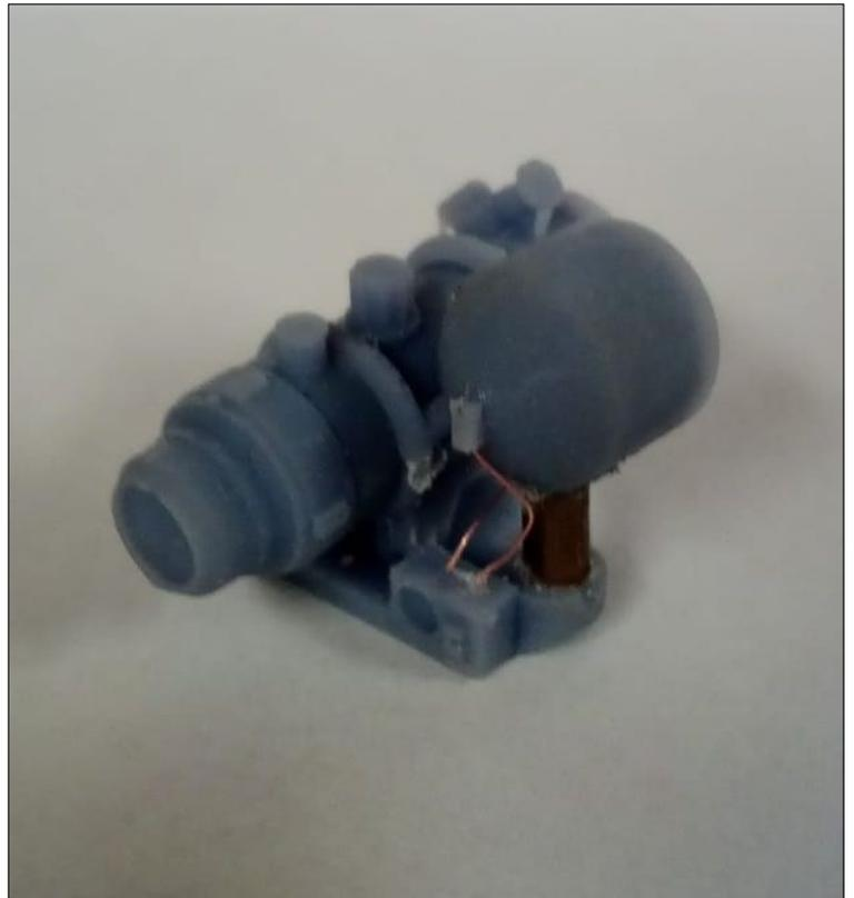
Bei diesem Umbausatz handelt es sich um ein 3D-Druck-Modell. Die Bauteile müssen vor dem Zusammenbau von Stützmaterial befreit und die Oberflächen eventuell verschliffen werden. Vor dem Verkleben bitte auf Passgenauigkeit achten. Die Einzelteile können farblich variieren, da verschiedene Drucker zur Produktion eingesetzt werden.
