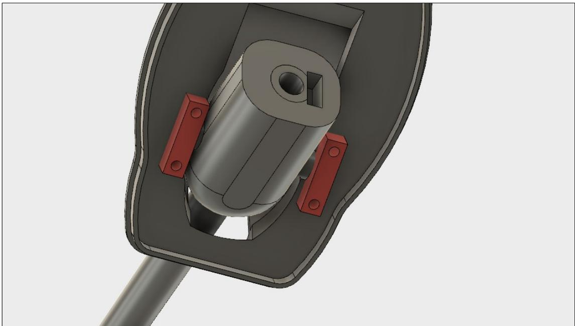
Die Halter mit den beigefügten Schrauben M2x10 befestigen.
