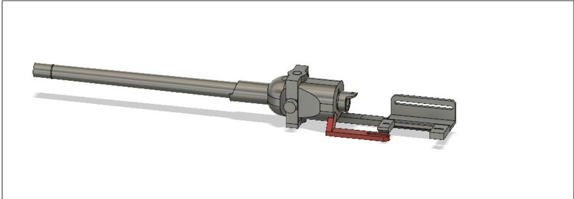
Kleben Sie den Seitenricht-Hebel in den Lagerblock
