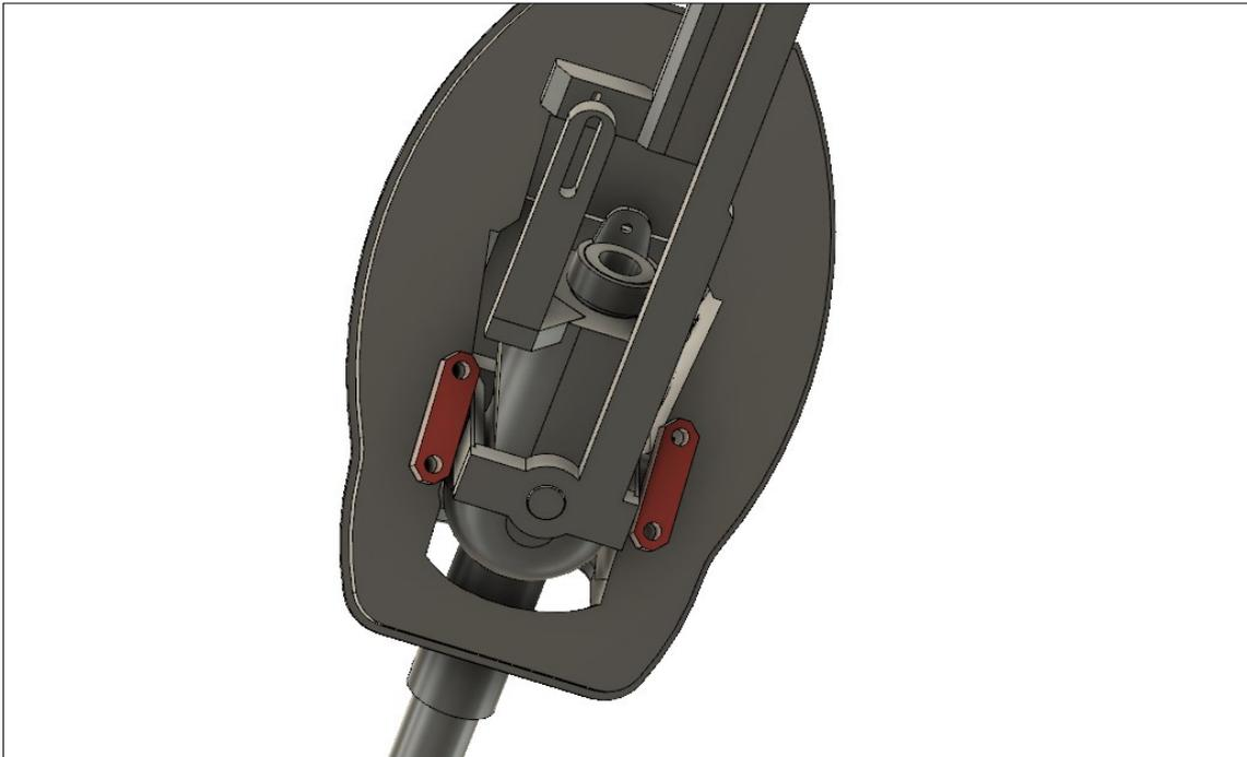
Die Halter mit den beigefügten Schrauben M2x10 befestigen.
