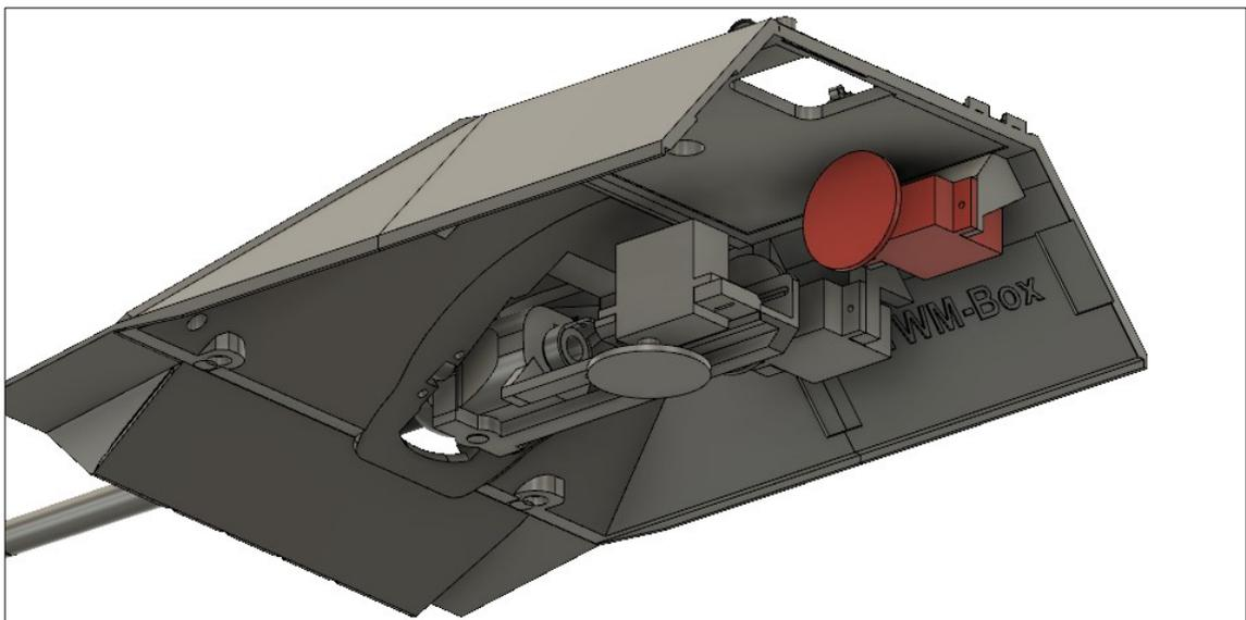
Das Rohrrückzugs-Servo festschrauben.
