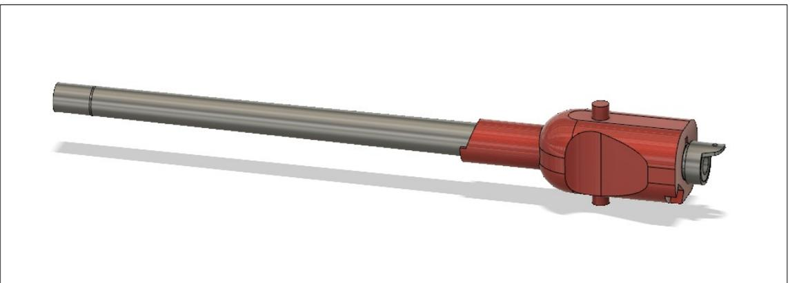
Überprüfen Sie, ob sich die KWK leichtgängig bis zum Mitnehmerring in den Lagerblock schieben lässt. Gegebenenfalls die KWK etwas abschleifen.
