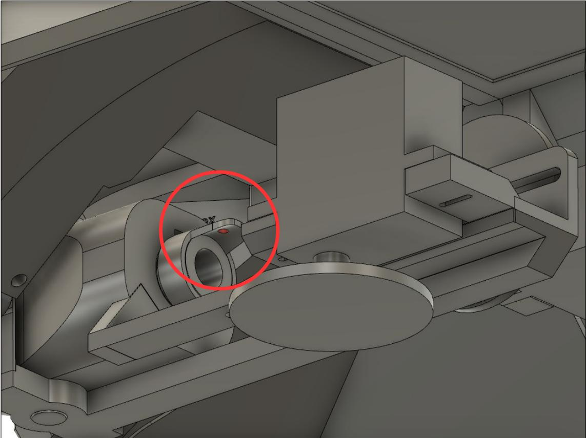
Aus dem Stahldraht einen Haken biegen und den Mitnehmerring mit dem Servohorn des Rohrrückzugs-Servos verbinden.
