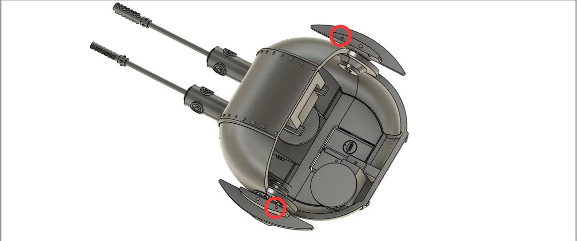
Kleben Sie in die markierten Bohrungen den mitgelieferten Stahldraht und lassen Sie ihn ca. 3 mm überstehen.
