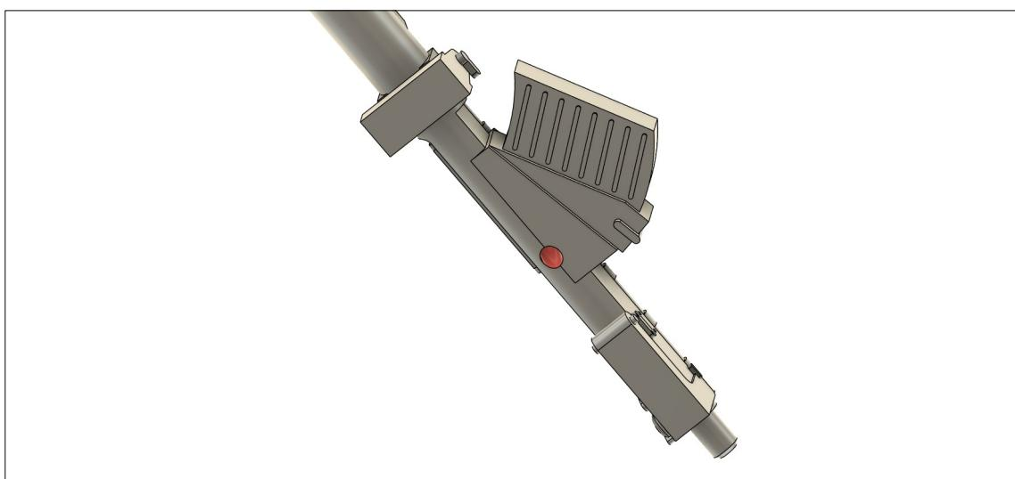
Soll ein Schußblitz eingebaut werden, kann durch die markierte Bohrung der 2 cm KWK ein 0,8 bis 1 mm Lichtwellenleiter gesteckt werden.
