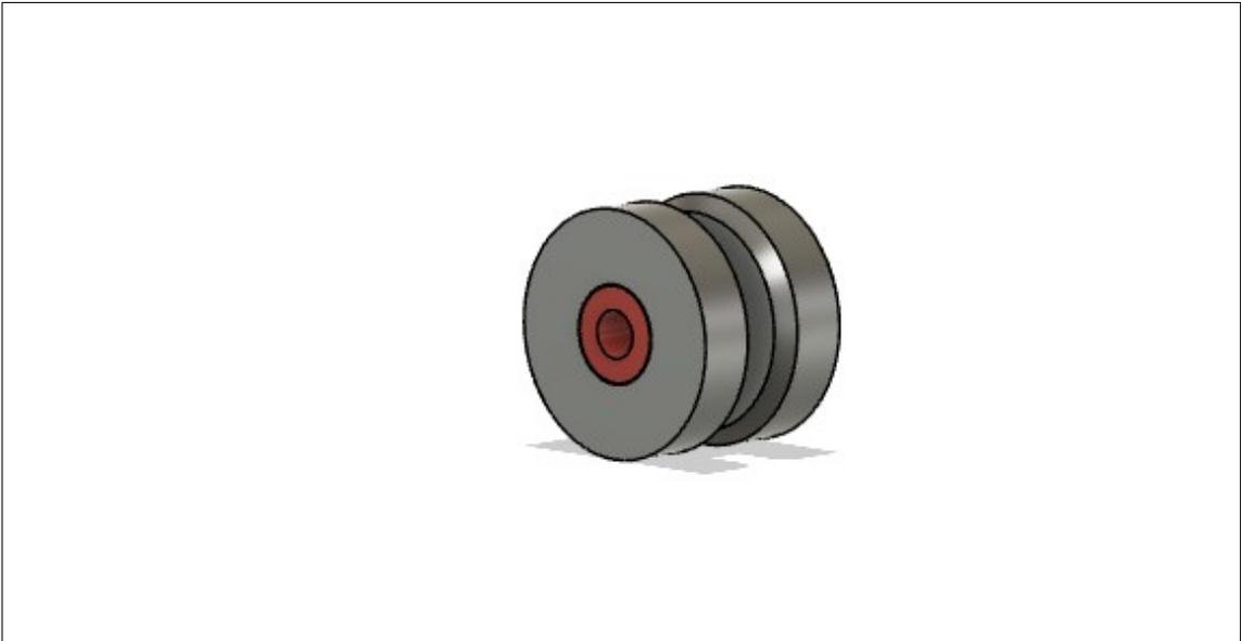
Kleben Sie in die beiden Stützrollen jeweils eine Alu-Buchse bündig mit der Rückseite ein.
