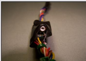
Da der Original-HL-Rohrrückzug (schwarz), der Nachrüst-Rohrrückzug (weiß) und die Schussfunktion („Erbсенkanone“) unterschiedliche Laufzeiten der Motoren benötigen, kann mit dem Potentiometer die individuell benötigte Laufzeit eingestellt werden.
