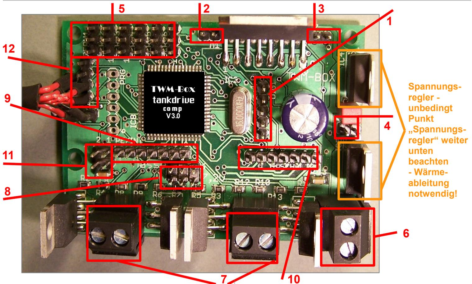
Spannungsregler - unbedingt Punkt „Spannungsregler“ weiter unten beachten - Wärmeableitung notwendig!
